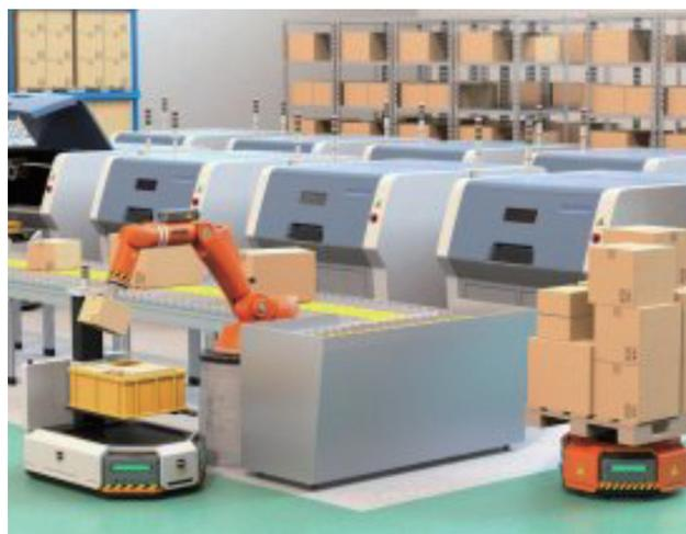
图4 通过安装机器人模块，任何仓库车辆都可以变成自动导向车
