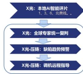
利用AI+视觉检测技术, 以及5G技术的融入, 实现全球X光智能评片与工艺闭环管控
